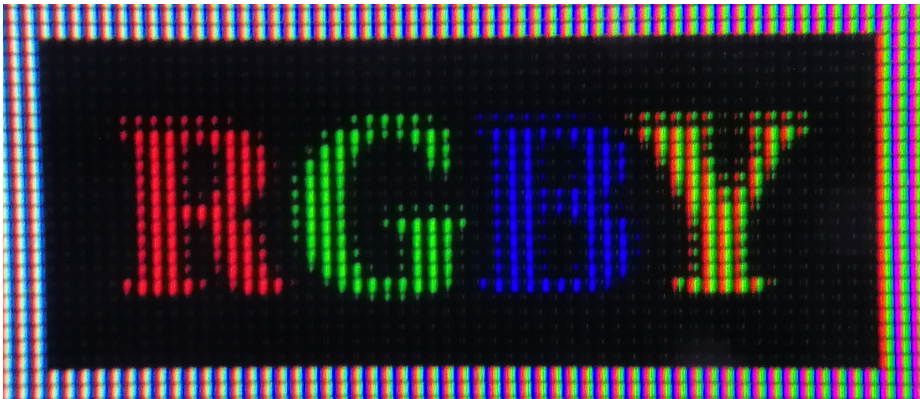
Nestekidenäytön pikseleitä suurennuslasin läpi nähtynä
